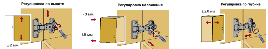
Рис.4 Схема регулировки петель
