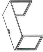
Опоры QUATTRO сечение трубы 40x40
