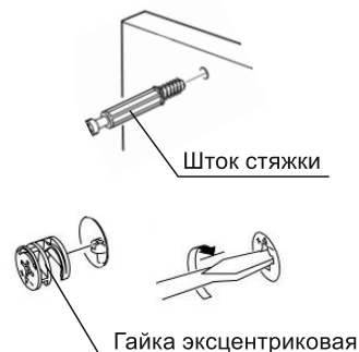
Схема 4. Установка стяжки эксцентриковой
