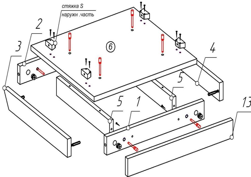
1. Прикрепить еврошурупами детали (5) к крышке (6). (Дополнительная разметка указывает на верхнюю сторону крышки)
