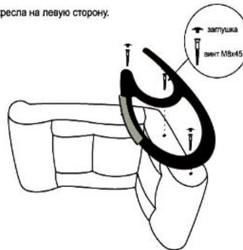
2. Взять правую боковину, у которой углубления под головки винтов на 3 отверстия должны быть с внешней стороны и положить соответствующим образом на бок мягкой части.
