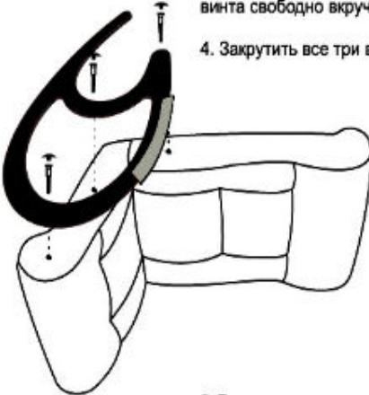
3. Взять 3 винта и вставив их в отверстия в боковине, наживить их, что бы все три винта свободно вкручивались во внутренние гайки каркаса мягкой части.
