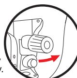
Поверните рукоятку против часовой стрелки, чтобы ослабить пружину.
