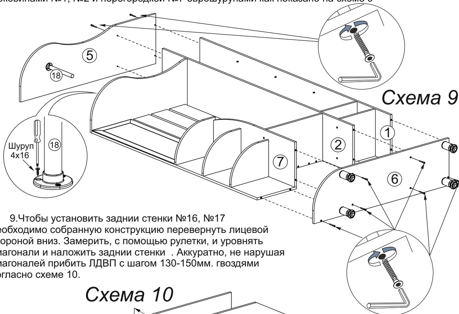
9. Чтобы установить задние стенки №16, №17 необходимо собранную конструкцию перевернуть лицевой стороной вниз. Замерить, с помощью рулетки, и уровнять диагонали и наложить задние стенки. Аккуратно, не нарушая диагоналей прибить ЛДВП с шагом 130-150мм. гвоздями согласно схеме 10.
