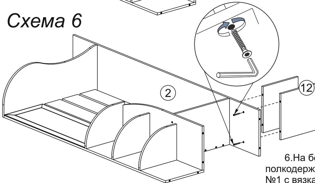
6.На боковину №1 установите полкодержатели. Соедините боковину №1 с вязками №12 с помощью еврошурупов как показано на схеме 7.
