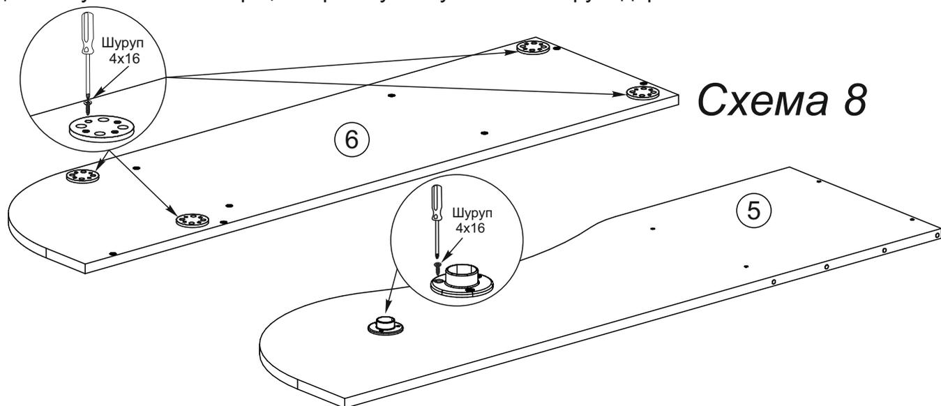
8. Соедините крышку №5, с установленной трубой №18, с боковинами №1 и №2, дно №6 с боковинами №1, №2 и перегородкой №7 еврошурупами как показано на схеме 9
