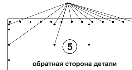
Схема 2. Досверливание отверстий (Ø8 мм) Правая сборка (дверь справа)
